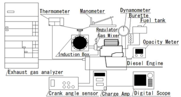
Fig. 2 Experimental apparatus
