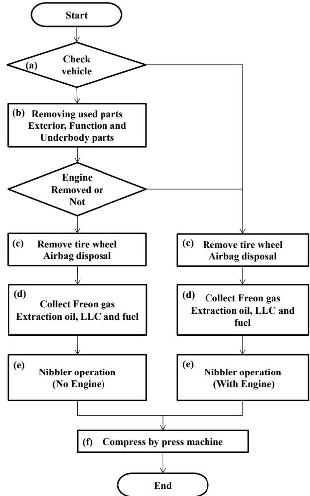
Fig. 2 Reuse flow
